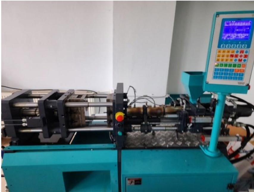
Şekil 2.2. Kullanılan enjeksiyon makinesi (Permak makine)
